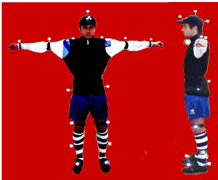
Figura 2. Ubicación de los marcadores del sistema óptico de seguimiento para la captura de movimiento del sistema CLIMA.
