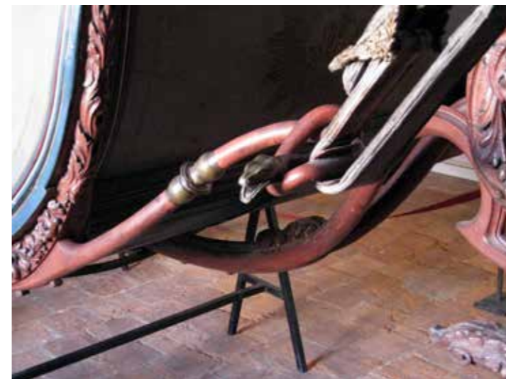
Fig. 5. Carroza, ¿manufactura novohispana de hacia 1800?, Museo Regional de Guadalupe, Zacatecas, México, detalle del anclaje de la caja al tren delantero.
